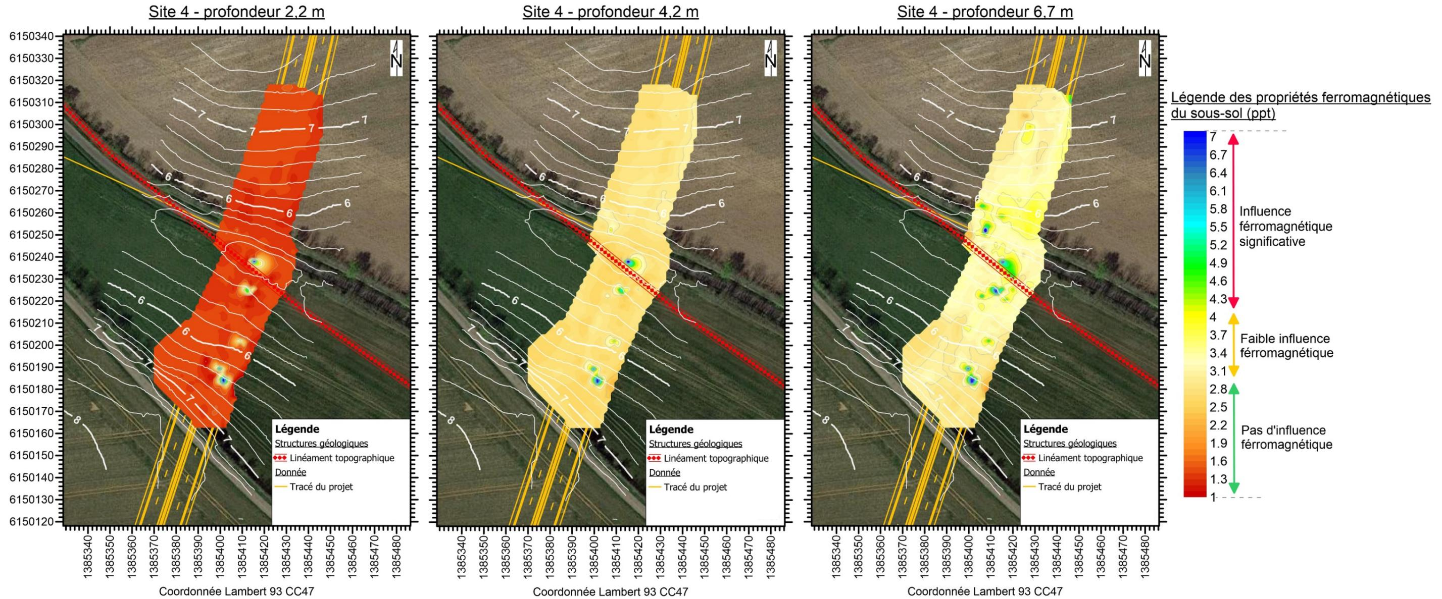
Figure 21 – Résultats des propriétés ferro-magnétiques du sous-sol aux 3 profondeurs d’investigation sur le site 4.
